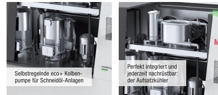
combiloop CL6 G 1200 als Emulsions-Version. Hier ausgestattet mit patentiertem Kompaktbandfilter, 25-kW-Aufsatzkühler, Emulsions-Entkeimung, filterbaren Abgängen u. v. m.
