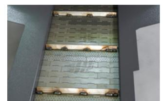
Une perforation sophistiquée empêche l'accumulation de fluide et favorise l'évacuation des copeaux. Nettoyage du fond de cuve intégré et silencieux par entraîneur en Vulkollan®. La bordure fermée empêche la pénétration des copeaux.
