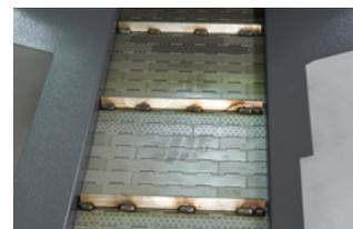
Una sofisticata perforazione evita il ristagno di fluidi contribuendo all'asportazione dei trucioli. Pulizia del fondo integrata e silenziosa con trascinatore in Vulkollan®. Il bordo chiuso impedisce l'infiltrazione di trucioli.
