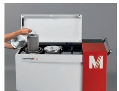
Remplacement rapide : Le double filtre commutable permet un remplacement rapide pendant le service – toujours sûr, propre et simple.
